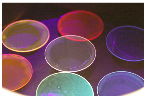
光の三原色&白色に光る高蛍光性ポリイミドのフィルム（紫外線励起）
