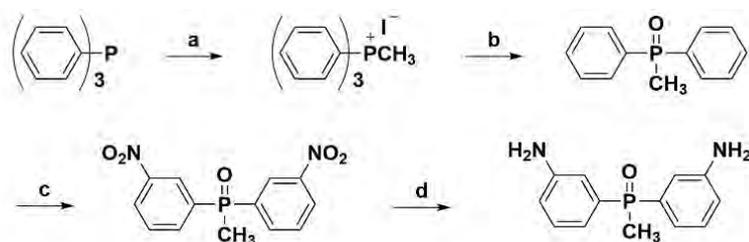
Reagents: a: MeI, Toluene (99%); b: aq. NaOH (30%); c:  $\text{HNO}_3/\text{H}_2\text{SO}_4$ ; d: Ethanol, Pd/C
