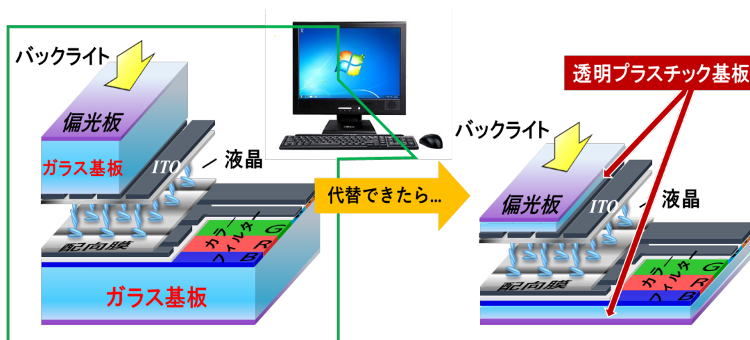
図1 液晶ディスプレイの断面模式
