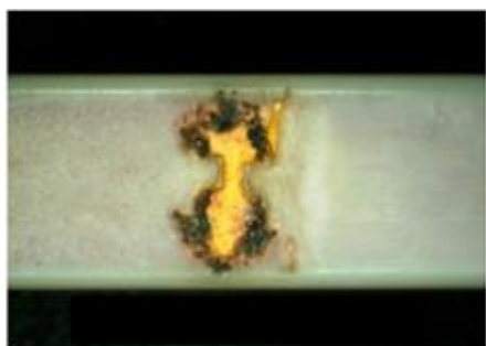
図 4. 放電劣化による絶縁破壊
