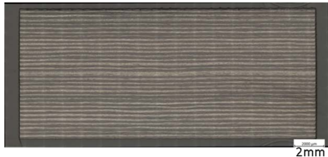
図4 TriA-X ポリイミド複合材料 ([0/90] 16s , 64 層) の断面顕微鏡写真
