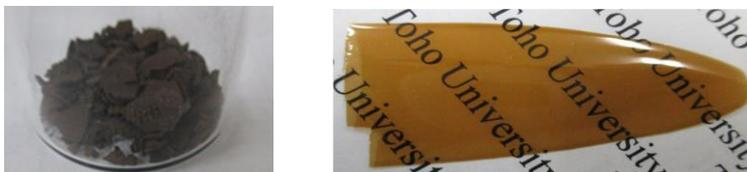
図5 モノマーX(プロトタイプ)の外観とX/4,4'-ODA系(#2)PIフィルム
