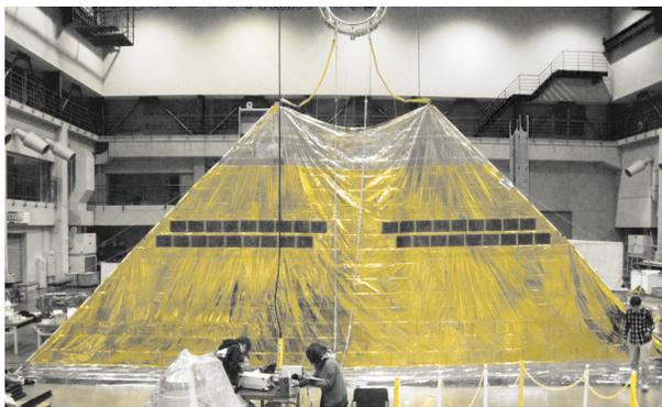
図6 IKAROSセイル膜1ペダルの地上展開評価(ポリイミド面)
