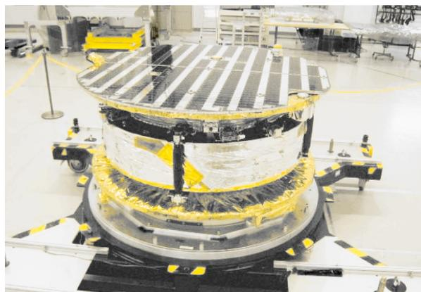
図1 IKAROS探査機(重量296 kg, 直径160 cm, 高さ83 cm)
