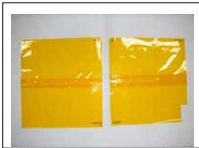
図 5、両面コート APICAL-AH12.5um の熱接着
