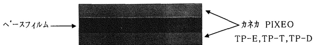
図5 カネカPIXEO BPタイプの3層構造の説明図
