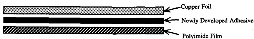
図-18. 耐熱接着フィルムを用いたFPC用銅張積層板.
